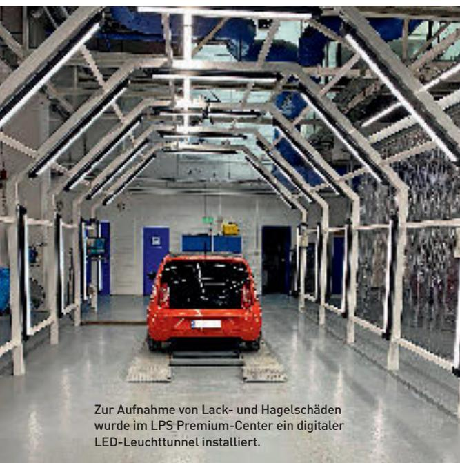
Zur Aufnahme von Lack- und Hagelschäden wurde im LPS Premium-Center ein digitaler LED-Leuchttunnel installiert.
